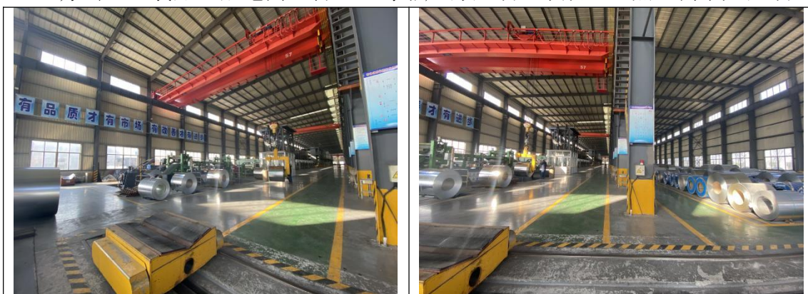
生产车间：生产过程中原辅材料可能对土壤和地下水产生污染，现场踏勘显示地面均已硬化，并铺设环氧地坪，地面完好无破损裂痕。
